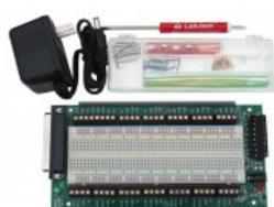
Morsetteria aggiuntiva per connettore DB37 con alimentatore, morsetteria e scheda per prototipi
