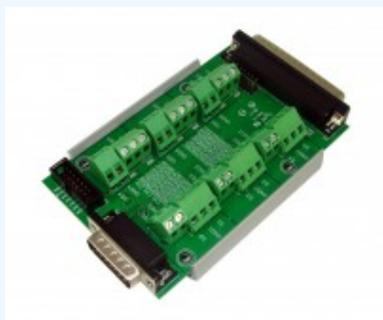
Scheda su connettore DB15, permette di avere a disposizione 12 switch (5-28V, 750mA), ciascuno con il proprio led di stato, isolato otticamente, con fusibile di protezione.
