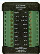
Amplificatore di segnale fino a due segnali, moltiplicatori configurabili x1, x10, x100, x1000
