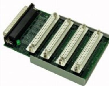
Scheda multiplexer su connettore DB37, permette di moltiplicare di 8 volte gli input analogici, portando ad 80 (in multiplexing) + 4 (normali) gli ingressi analogici. Disponibile anche in versione OEM.
