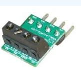
Modulo per aggiungere due switch fino a 50V e 200mA, servono due uscite digitali libere.
