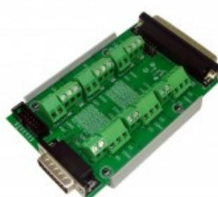
Scheda su connettore DB15, permette di avere a disposizione 12 switch (5-28V, 750mA), ciascuno con il proprio led di stato, isolato otticamente, con fusibile di protezione.
