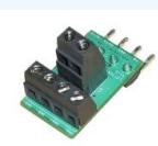
Modulo adatto a convertire i segnali 4-20mA in Volts. Soluzione già pronta al posto delle solite resistenze.
